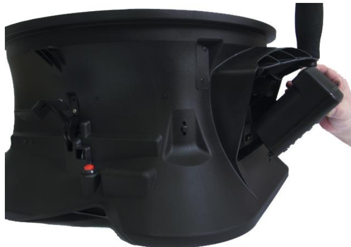
Figura 10: Colocando el Medidor a la Base de Campana de Captura
