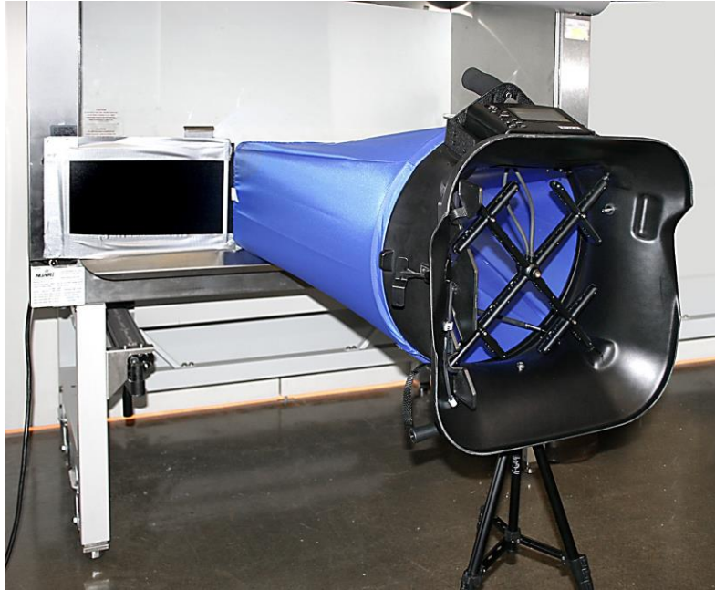
Figura 28: Ajuste de Altura y Posición del Soporte Telescópico
