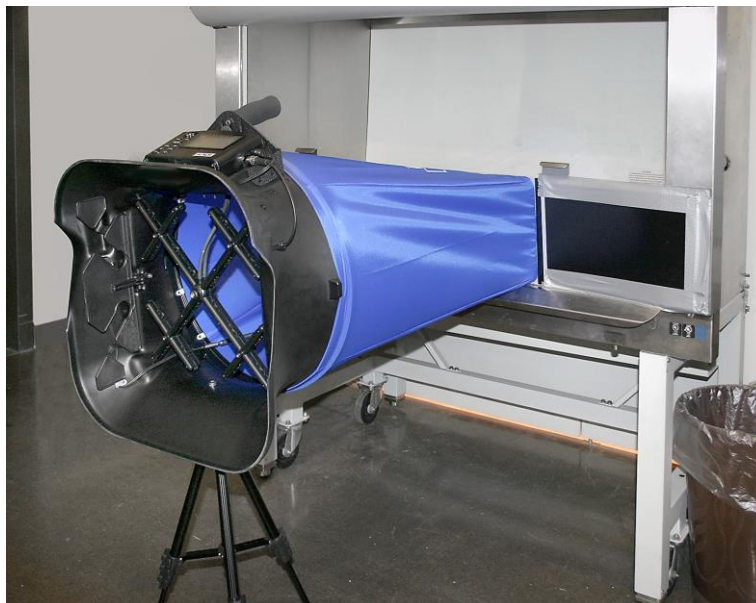
Figura 23: Medición de Flujo de Entrada Directo de Campana
