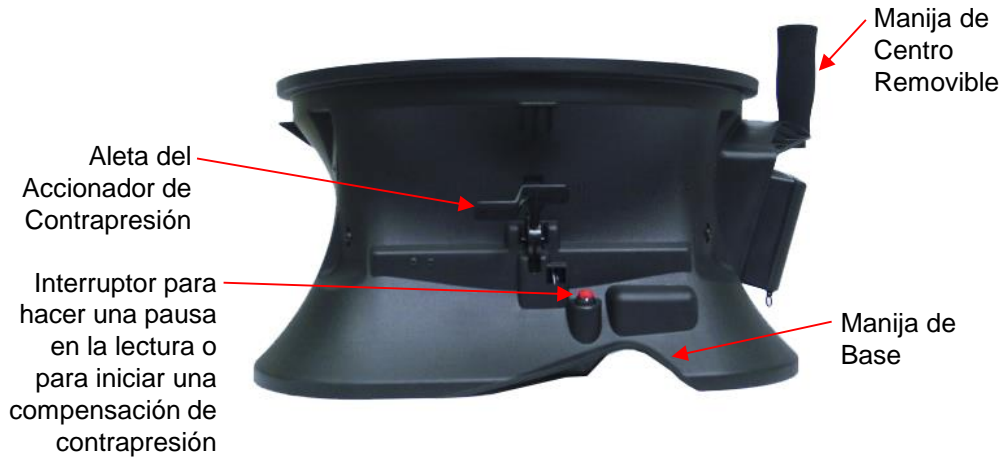
Figura 3: Características del EBT Balometer® Base, Vista de costado
