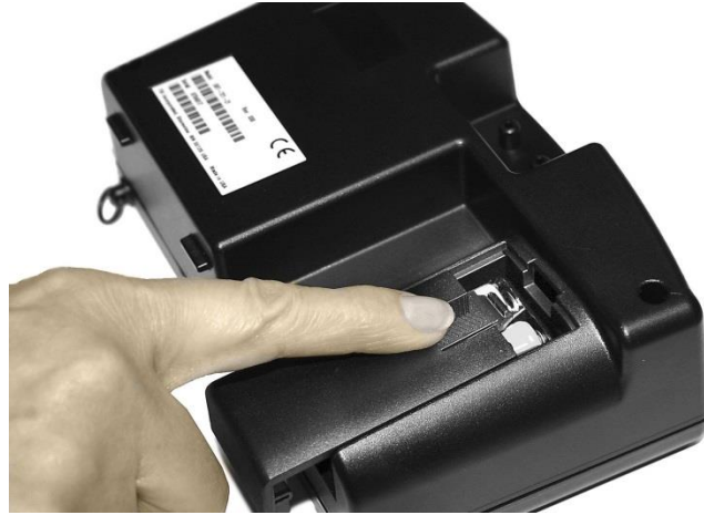
Figura 5: Desmontaje de la cubierta de la batería
